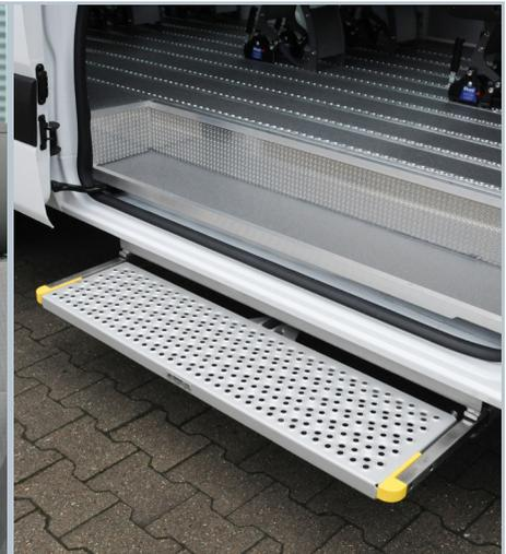
Die elektrische Trittstufe ermöglicht einen bequemen Seiteneinstieg.
