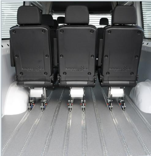
Der Smartfloor Aluminium-Systemboden ermöglicht eine flexible Nutzung des Fahrzeuges.
